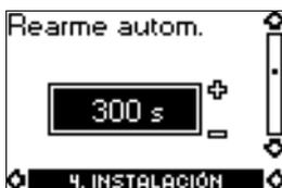
Ajustar el tiempo que debe transcurrir hasta que el MP 204 intente el rearme automático del motor después de un disparo.
