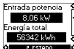
Entrada de potencia real y consumo de energía del motor.
