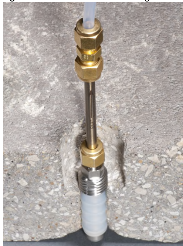
Figura 7. FLX-VP® con conexión de tubo Sorbent TO-17
