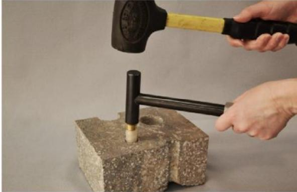
**Figura 2.** Instalación de Vapor Pin®
