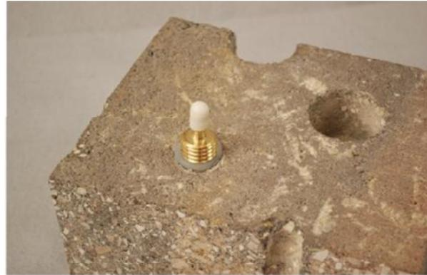
**Figura 4.** Vapor Pin® instalado.
