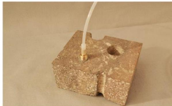
**Figura 5.** Conexión de muestra de Vapor Pin®
