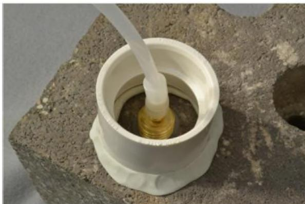
**Figura 6.** Contenedor de agua utilizado para detectar fugas.
