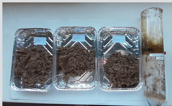
Aspecto de las columnas al final del experimento y muestras de las diferentes zonas de la columna.
