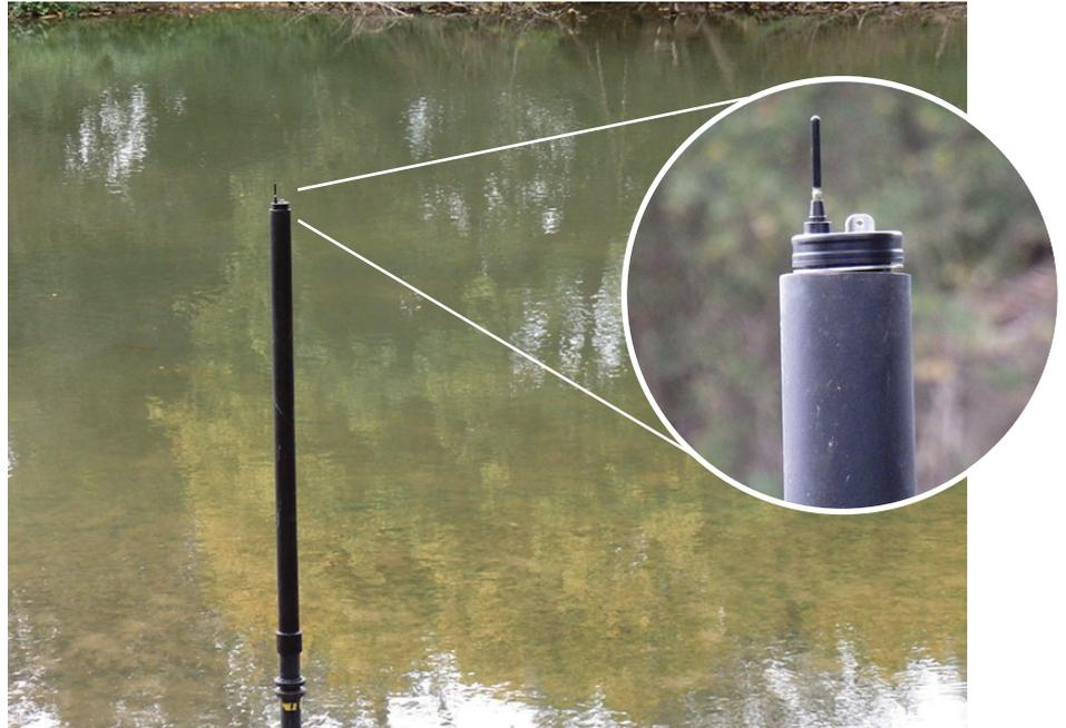
*Con la instalación de la última sonda Levelogger para el registro en continuo de datos de nivel y temperatura de la zona del Baix Ter se da por concluida la campaña de instalación de sensores para el proyecto PECT.*
