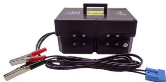
Regulación constante del voltaje. Permite realizar la regulación del caudal de las bombas 12 Voltios. Incluye protección anti-cambio de polaridad y protección térmica. Sistema de paro de la bomba. Se puede regular bajo caudal hasta 40 ml/min. Para la bomba MEGA-MONSOON.
