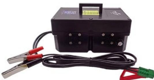
Regulación constante del voltaje. Permite realizar la regulación del caudal de las bombas 12 Voltios. Incluye protección anti-cambio de polaridad y protección térmico. Sistema de paro de la bomba. Se puede regular bajo caudal hasta 40 ml/min. Para las bombas MONSOON y HURRICANE.
