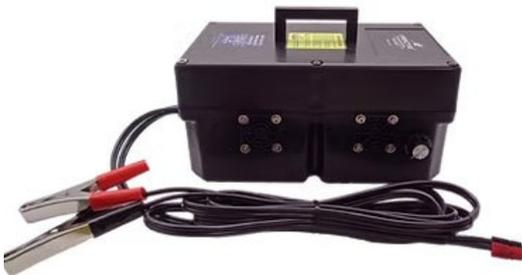
Permite realizar regulación del caudal de las bombas 12 Voltios. Incluye protección anti-cambio de polaridad y protección térmica. Sistema de paro de la bomba. Se puede regular bajo caudal hasta 40ml/min. Para las bombas MINI-TYPHOON, MINI MONSOON, TWISTER, TORNADO Y SUPER TWISTER.
