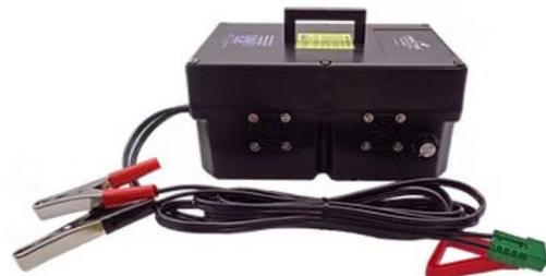
Regulación constante del voltaje (incrementa la salida de voltaje de la batería de 12v a 24v constantes). Permite realizar la regulación del caudal de las bombas 12 Voltios pero no para el muestreo low flow. Incluye protección anti-cambio de polaridad y protección térmica. Para las bombas MONSOON y HURRICANE.
