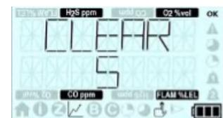
Le mode crête peut également être utile pendant les vérifications avant entrée dans un espace confiné. Le mode crête peut être sélectionné et le **T4** introduit dans la zone à contrôler. Quand le **T4** est ensuite retiré de l'espace, les relevés de crête de gaz seront affichés à l'écran. Une alarme peut être annulée et les valeurs de crête de gaz continueront à être affichées à l'écran.
