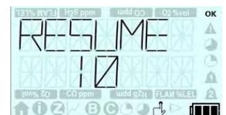
Si le **T4** est maintenant utilisé par un nouvel opérateur et que de la fonction Resume TWA n'est pas requise, ne pas cliquer sur le bouton de commande et attendre l'expiration du compte à rebours. Ceci permet de remettre les valeurs STEL, TWA et de crête à zéro.
