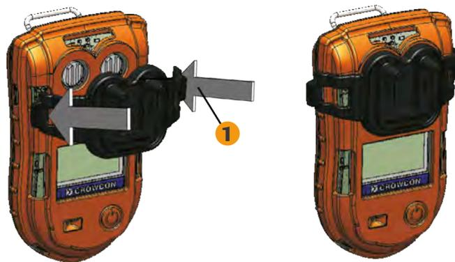
L'extrémité flexible de la poire aspirante manuelle doit ensuite être raccordée à l'orifice de la plaque aspirante **1** à droite (lorsqu'on observe à partir de l'avant), à côté de la flèche sur la plaque aspirante.
