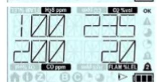
Si un capteur de gaz toxiques est installé, cet écran affiche les niveaux d'alarme STEL configurés (voir la [Section 2.3.3](#)).
