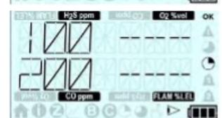
Si un capteur de gaz toxiques est installé, cet écran affiche les niveaux d'alarme TWA configurés (voir la [Section 2.3.4](#)).
