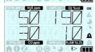
Cet écran affiche les niveaux d'alarme haute des capteurs configurés.
