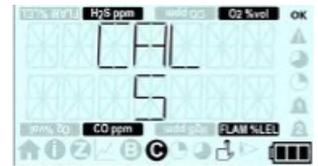
Pour lancer le calibrage, appuyer sur le bouton de commande avant que le compte à rebours se termine.
