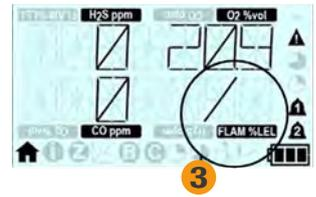
Pendant le mode de sauvegarde et la période de stabilisation qui suit, le niveau de gaz affiché sur l'écran LCD indiquera qu'il est hors de la plage des mesures. Comme le capteur a été exposé à un niveau de gaz suffisant pour provoquer un dépassement de la plage des mesures du capteur, le **T4** devra subir un essai de gaz pour s'assurer qu'il n'a subi aucun dommage durable.
