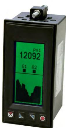
L'indicatore per il trasmettitore elettronico di livello deve essere utilizzato in zona sicura e montato in un idoneo quadro elettrico.
