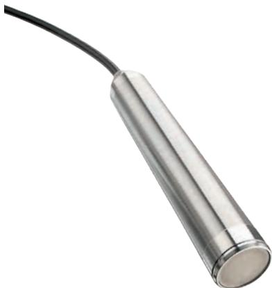
Il trasmettitore di livello è un sensore di pressione piezoelettrico che viene utilizzato in immersione per misurare il livello di un liquido e per fornire un segnale analogico a un sistema di controllo. Il trasmettitore è appositamente sviluppato per resistere in ambienti difficili ed abbinabile alle elettropompe Officine di Trevi nel caso di pompaggio di acque chiare, acque reflue, percolato, idrocarburi.
