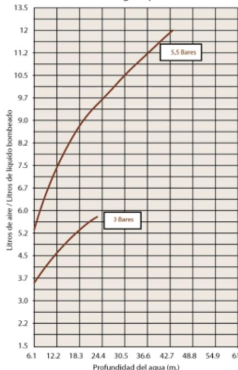
Tubería descarga líquido 25mm. O.D.
