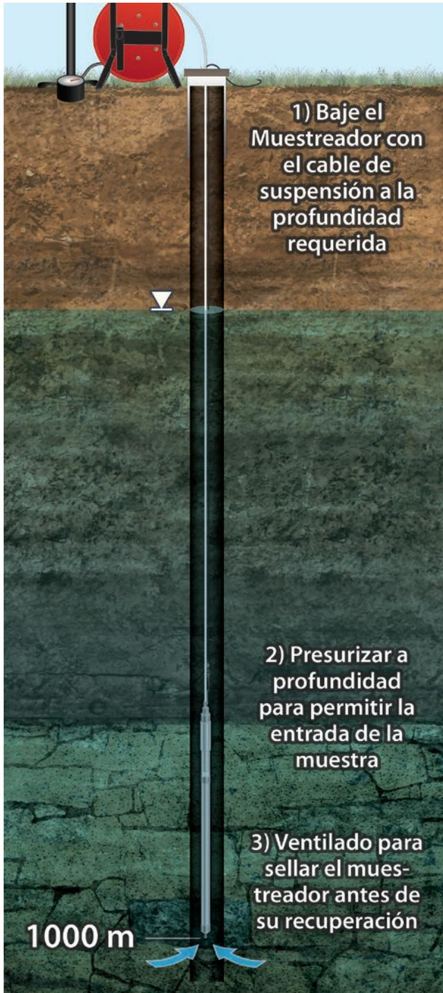
**Principios de funcionamiento del DIS de muestreo profundo**
