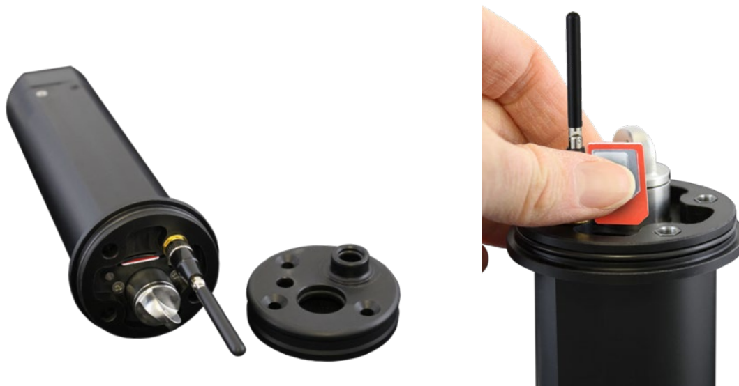
Figura 2-3 Instalación de la tarjeta SIM
