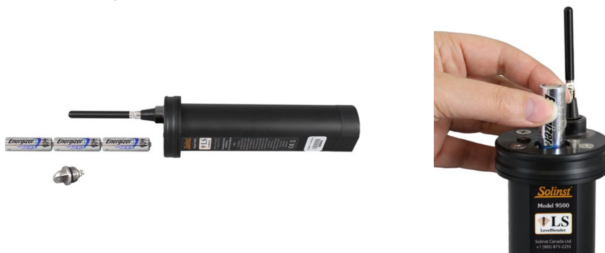
Figura 2-4 Instalación de las pilas
