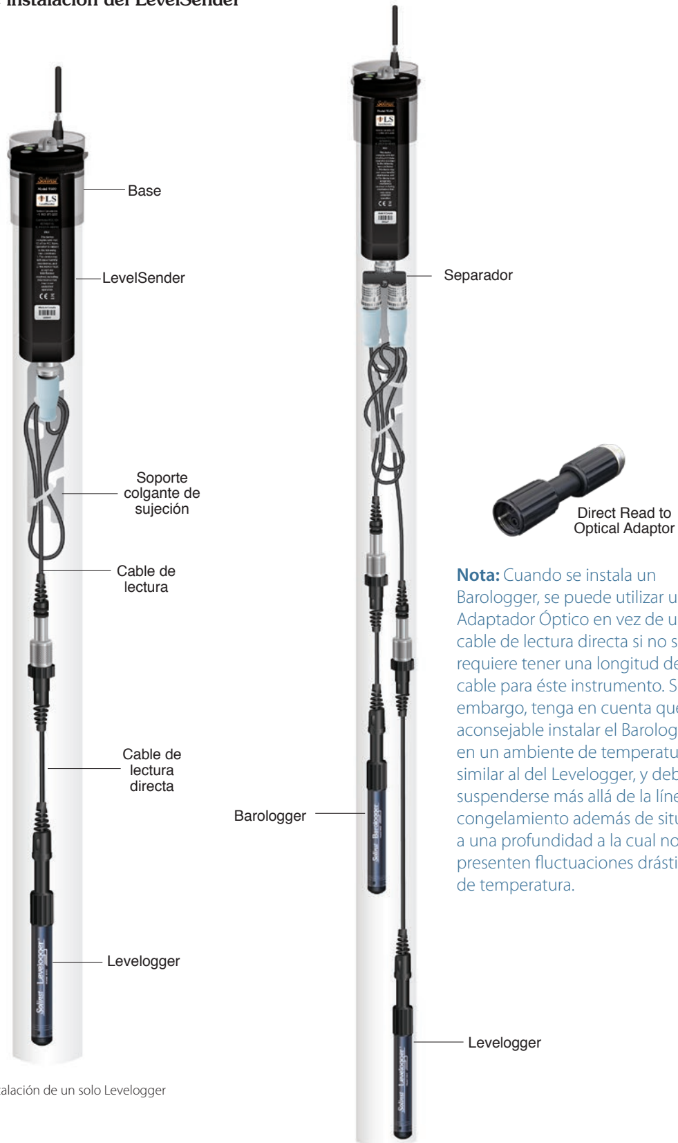
Figure 6-11 Instalación del Levellogger y el Barologger (con las conexiones del cable de lectura de forma escalonada)
