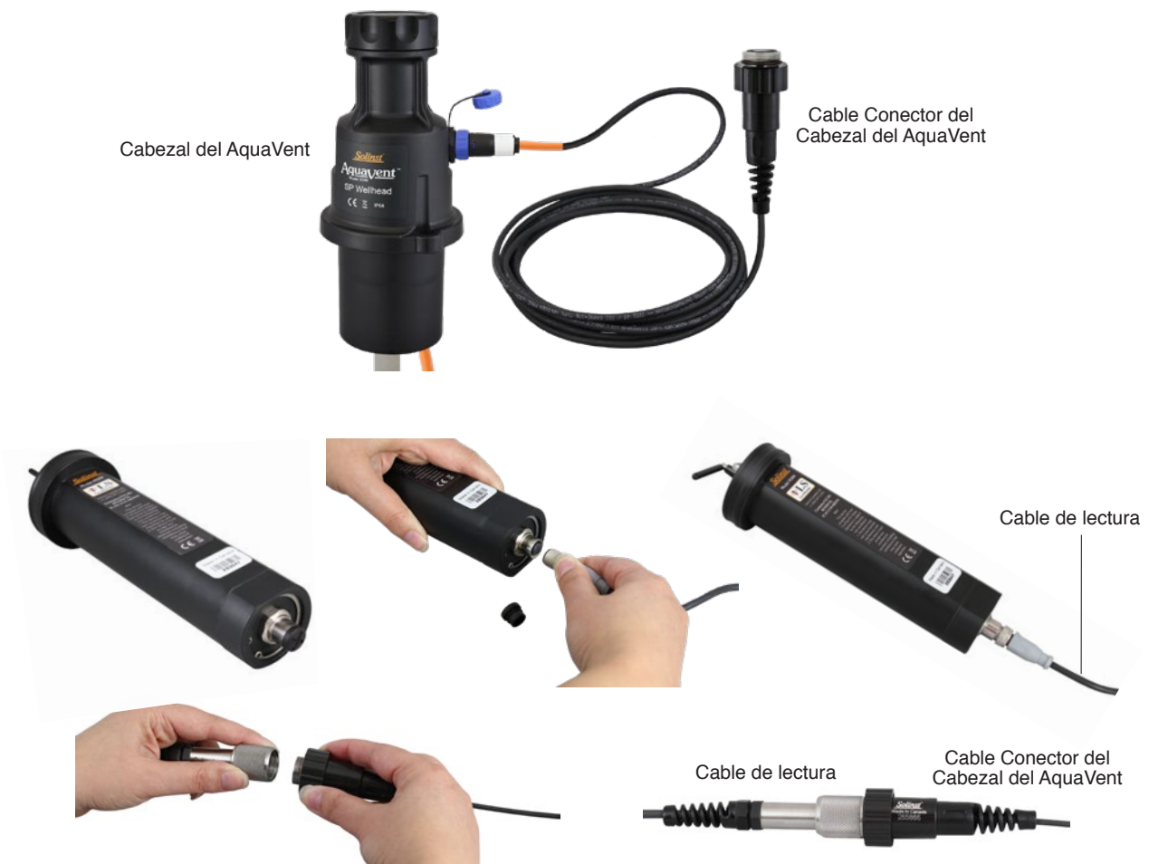
Figura 2-7 Conectando un AquaVent
