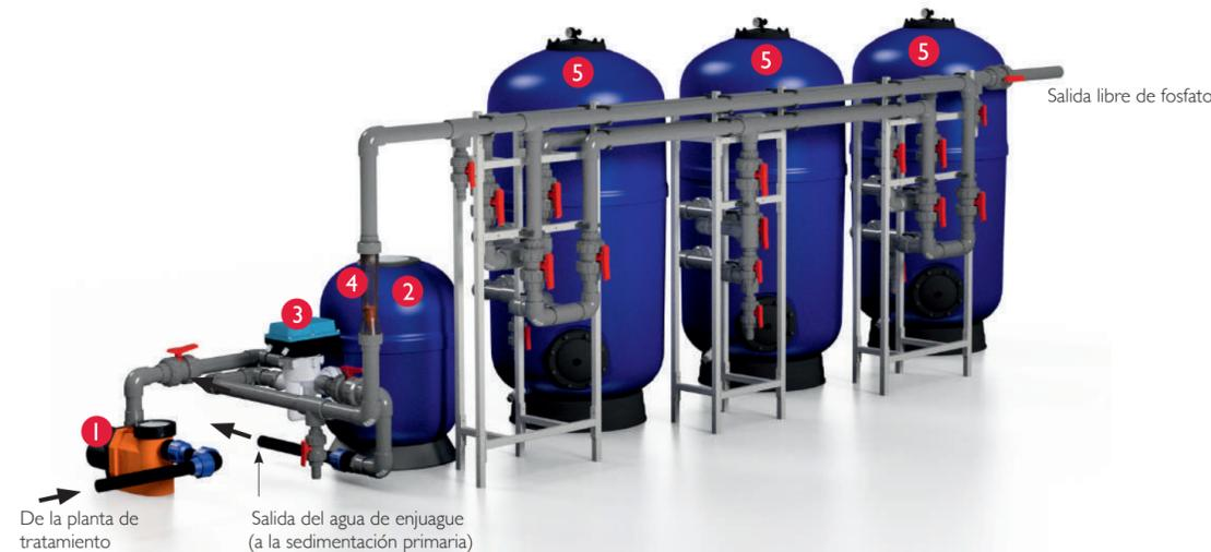
1 Bomba de succión · 2 Filtro de arena · 3 Válvula de seis vías (manual o automática) · 4 Caudalímetro · 5 Adsorción de fosfato
