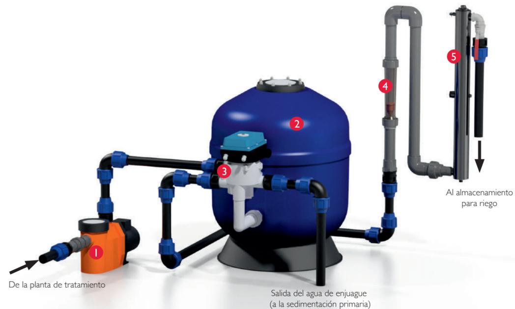
1 Bomba de succión · 2 Filtro de arena · 3 Válvula de seis vías (manual o automática) · 4 Caudalímetro · 5 Reactor ultravioleta
