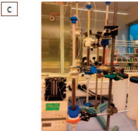
A) Sistema completo del ensayo de las columnas; B) Recipientes con surfactante (input del sistema); C) Detalle de las columnas; D) Muestreo del output.
