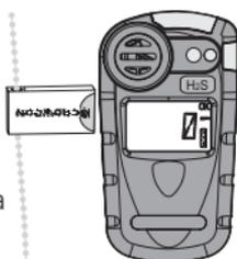
3. Toque el imán alineado verticalmente en la caja hasta el lado izquierdo de la pantalla. El detector Gasman activará la prueba de gas y visualizará 'TEST' en la pantalla.
