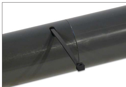
Figura 5-4 Empuje la cinta de esfuerzo a través de la ventana
