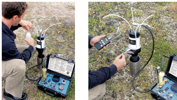
Figura 7-1 Comprobación de bombas y transductores
