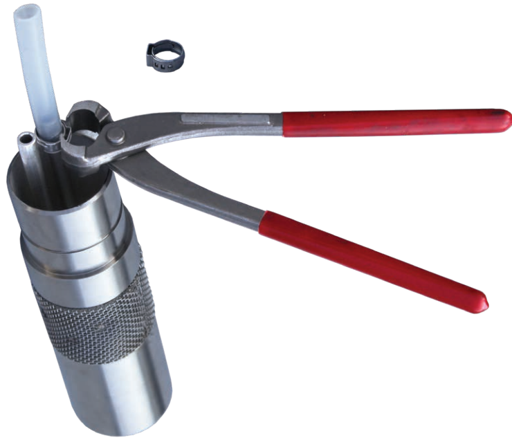
Figura 6-4 Tubería de 1/2" de DE x 3/8" DI conectada al vástago del puerto usando una abrazadera Oetiker N.º 14
