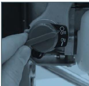
Posicionar el acelerador en la posición de velocidad lenta. Girar el interruptor a la posición de apagado (0).
