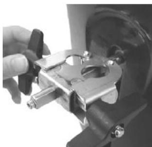
Una vez fijado, pasar la tubería de la bomba inercial por las aberturas del grosor adecuado (existen dos aberturas diferentes, caudal estándar o alto caudal). Una vez la tubería se encuentra en la posición adecuada, ajustar las aberturas girando las manivelas para una mejor sujeción del tubo.
