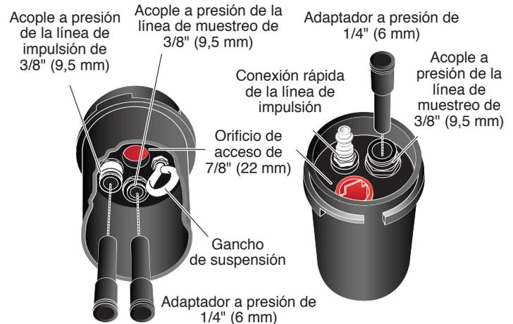
Los cabezales de pozo están provistos con tres adaptadores a presión de 1/4" para posibilitar el uso de tuberías de 1/4" o 3/8", según se prefiera.
