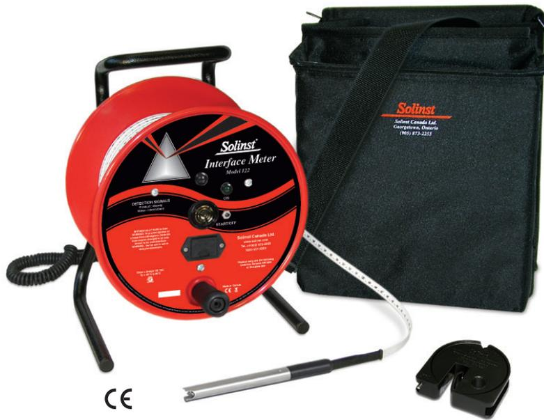
Si solo hay agua en el pozo, solo habrá señales intermitentes (agua). La presencia o ausencia de capas densas (que se hundan) en fase no acuosa (DNAPL) se determina bajando nuevamente la sonda hasta el fondo de un pozo.
