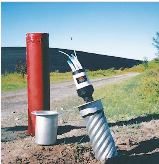
Una investigación de propiedades hidráulicas debajo de un gran sitio de desechos. Se eligieron sistemas Waterloo de niveles múltiples para realizar muestreo de calidad del agua y poder determinar la zonas con mayor permeabilidad dentro del acuífero.
