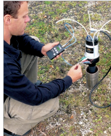
Recolección de una muestra desde un DVP dedicado y toma de mediciones de presión con el modelo 404 de lectura de cuerda vibrante Geokon (arriba).
