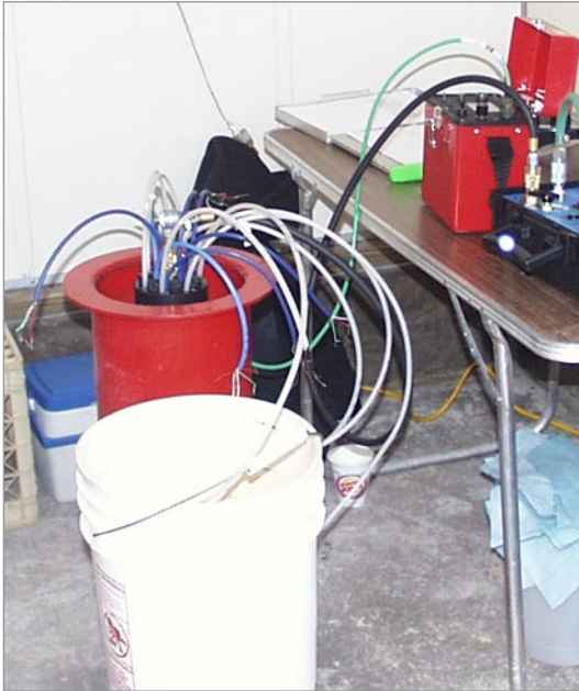
Se instalaron cuatro sistemas Waterloo para monitorizar una liberación de compuesto clorado. Se instalaron sistemas en profundidades que oscilaban desde 430 pies a 750 pies, con 7 zonas de monitorización. Los puertos fueron construidos con bombas de doble válvula y transductores de cable vibrante.
