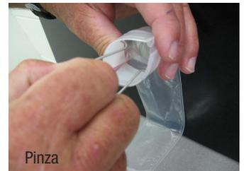
HydraSleeve™, como todos los muestreadores pasivos, obtienen un limitado volumen de muestra basado en su diámetro y largo. Constatar con vuestro laboratorio y preguntar por el mínimo volumen requerido de vuestro interés.
