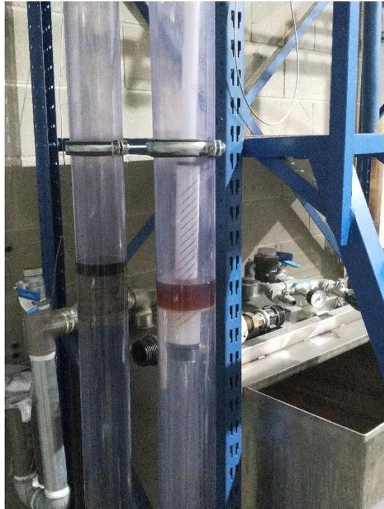
Tras 45 minutos desde la instalación se vuelve a comprobar el estado y la fase se ha reducido a 2cm de espesor.
