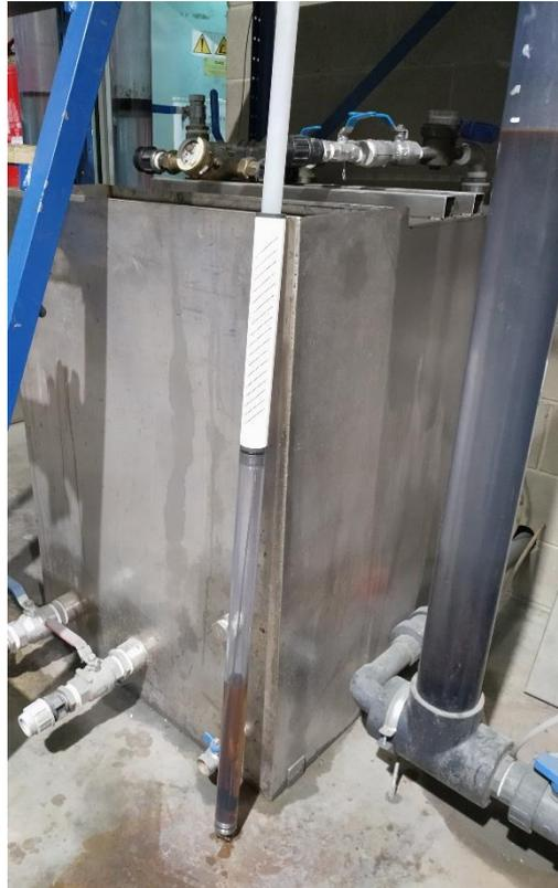
El Skimmer muestra un funcionamiento óptimo. El motivo por el que no funcionase en obra podría ir vinculado a la viscosidad del producto a recuperar, cabe la posibilidad que, aunque en todos los puntos tengamos Diesel, puedan existir valores de viscosidad o densidad diferentes por procesos de cierta volatilización, degradación, u otra cosa dependiendo de las condiciones. Según datos del fabricante la viscosidad máxima de funcionamiento de la membrana es de 50 sqmm, en densidad +/- 0.85.
