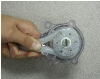
3. Gire el rotor en dirección contraria al reloj hasta que la manguera rodee completamente al rotor.
