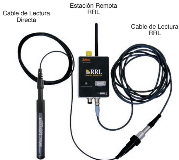
El sistema **RRL Remote Radio Link** utiliza radios para distancias cortas para enviar la data de nivel de agua recogida por los Leveloggers, al Radio conectado al computador de la estación base.
