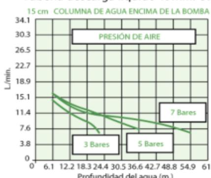
Tubería descarga líquido 25mm. O.D.
