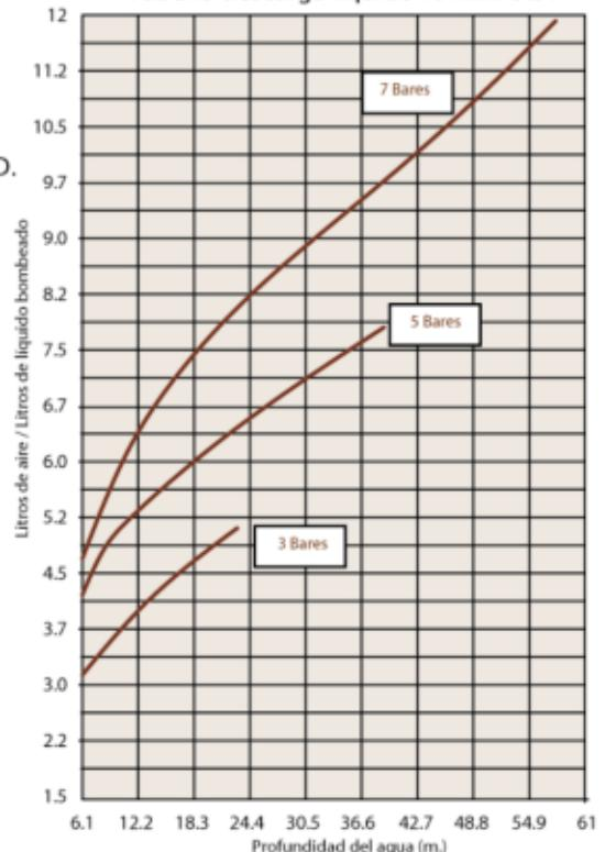
Tubería descarga líquido 25mm. O.D.
