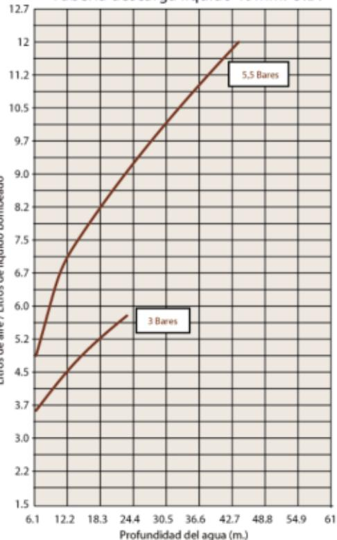
Tubería descarga líquido 25mm. O.D.
