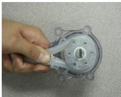
3. Gire el rotor en dirección contraria al reloj hasta que la manguera rodee completamente al rotor.
